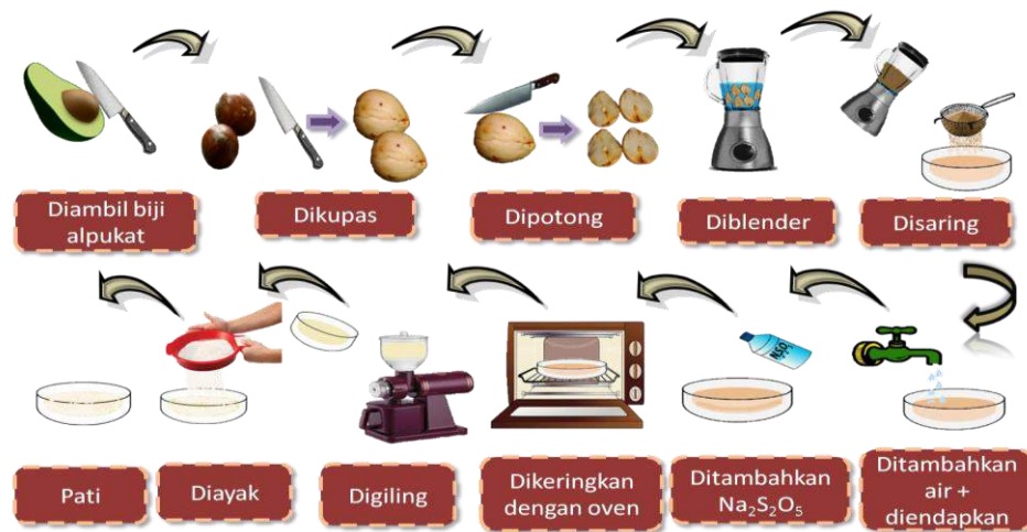
Gambar 2.5.1 Diagram Alir Ekstraksi Pati Biji Alpukat (Modifikasi Lubis, 2008)
